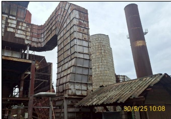
ภาพที่ 2.2-1 ระบบดักฝุ่นแบบมัลติไซโคลน
